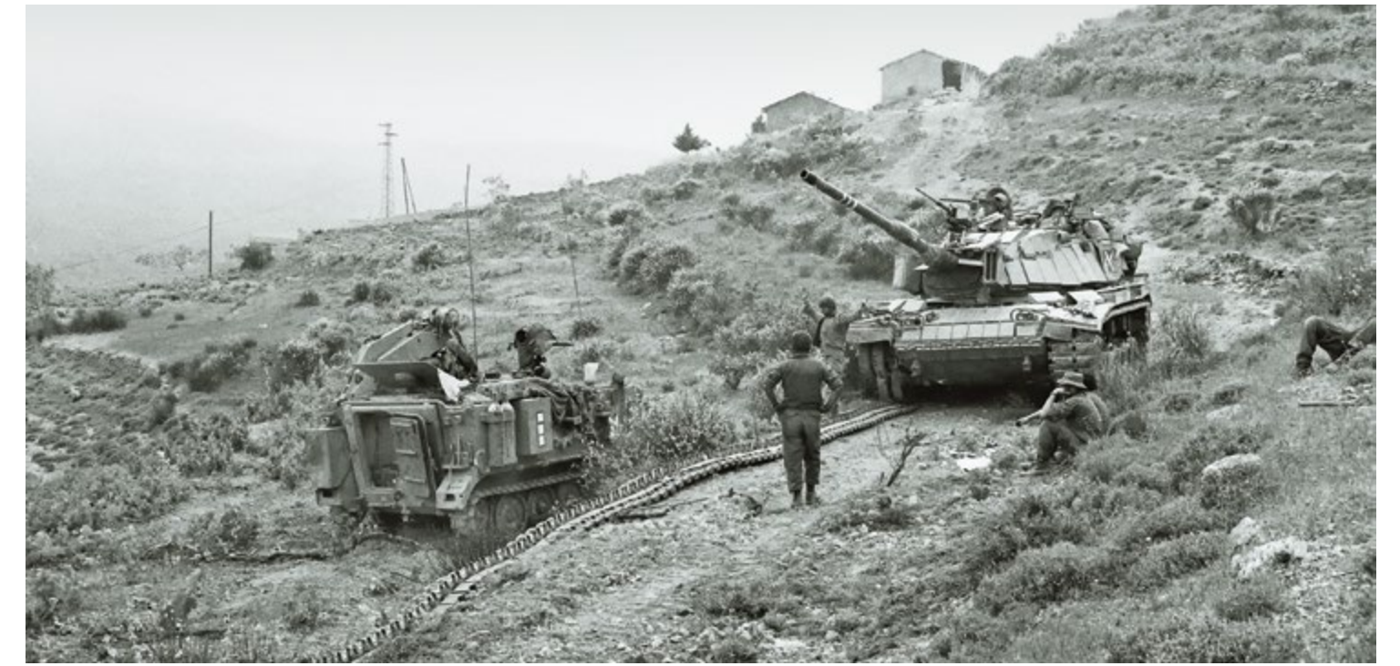
צוות נגמ"ש חימוש אמ-579 מתקן תקלה בטנק מגח מגדוד 195, שפרס זחל בדרך צפונה
