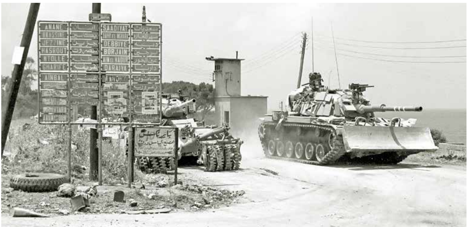
צפון צידון. טנק מגח עם ערכת דחפור וטנק שוט עם ערכת 'נוכרי' לפריצת שדות מוקשים
