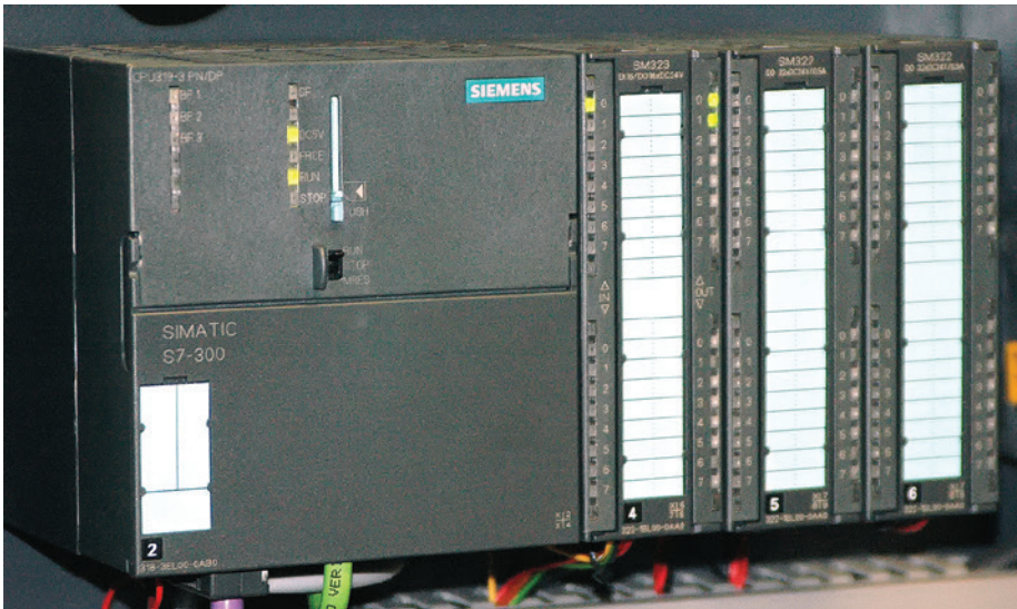
תמונה 2: אחד הרכיבים בהם פגעה התולעת סטוקסנט - בקר תעשייתי מתוצרת חברת סימנס (צילום: Ulli1105) 10
