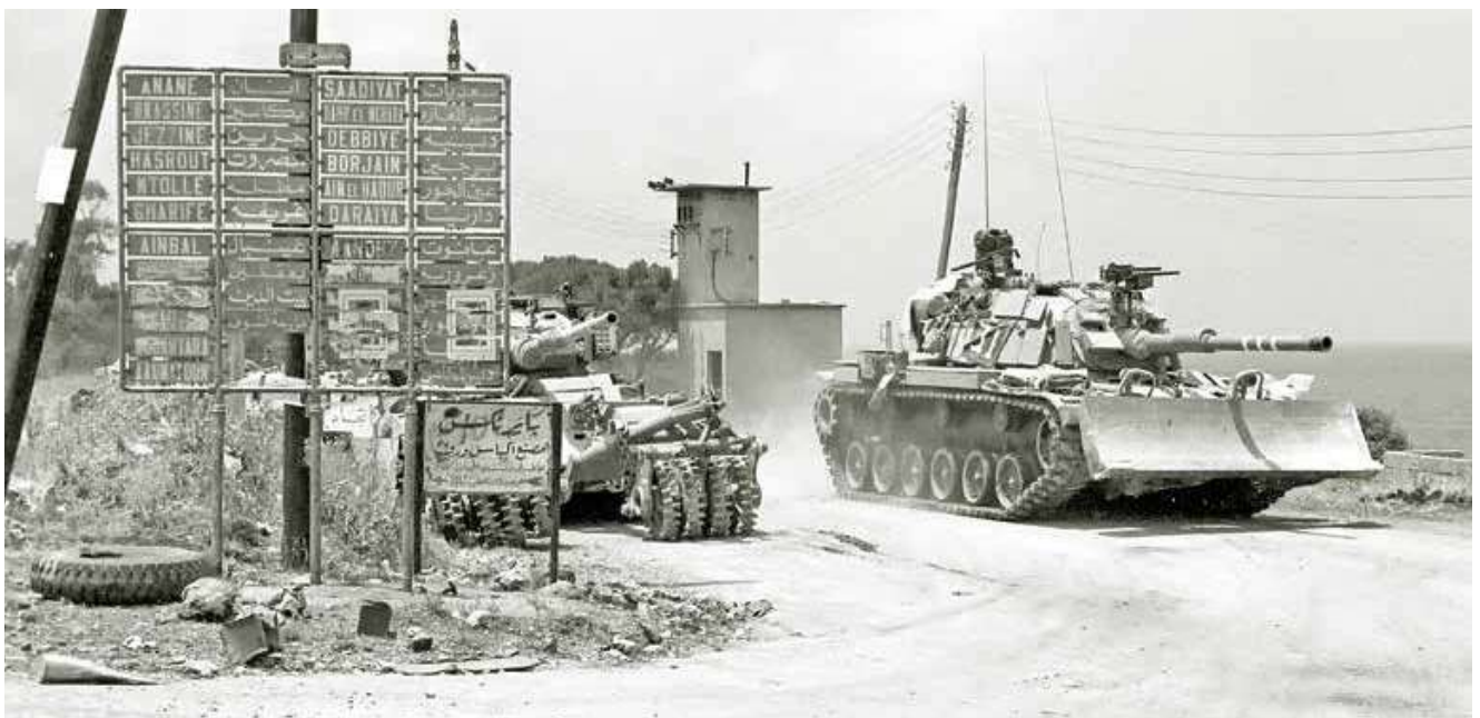
צפון צידון. טנק מגח עם ערכת דחפור וטנק שוט עם ערכת 'נוכרי' לפריצת שדות מוקשים
