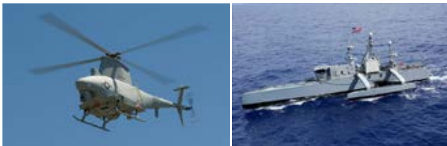
פלטפורמות בלתי מאוישות לגילוי צוללות: מימין: כלי שיט אוטונומי לגילוי צוללות מדגם Sea Hunter. משמאל: כט"מ MQ-8 Firescout. שניהם בשירות הצי האמריקאי (מקור: ויקיפדיה)
