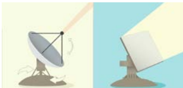
תצורת מכ"ם Phased Array (ימין) ומכ"ם מסתובב (שמאל) (מקור: המחברים)
