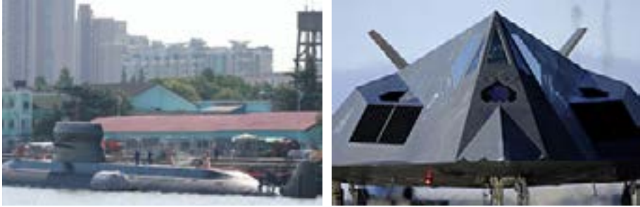
מימין: מטוס חמקן מדגם F-117 של חיל האוויר האמריקאי. משמאל: צוללת סינית מדגם Yuan 039C. שתי הפלטפורמות בנויות עם זוויות חדות למזער חזר ממקורות שידור אקטיביים (מקור: ויקיפדיה)
