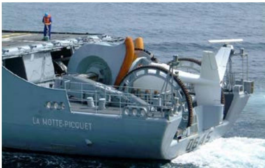
סונאר אקטיבי VDS מדגם DUBV-43 המותקן בירכתי אוניית המלחמה הצרפתית La Motte-Picquet. מערכת הסונאר מורדת למים באמצעות כננת וכבל ונגררת בעומק שקבע המפעיל (מקור: ויקיפדיה)
