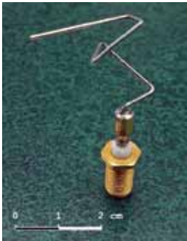
תמונה 37: אנטנה לחללית ST5 של נאס"א (2006) שעוצבה על ידי תוכנת חיפוש אבולוציוני להיות אופטימאלית מבחינת קרינה. (NASA)
